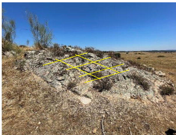
Fotografia 6.16 – Afloramento de tonalitos com tonalidade rosada e fraturação ortogonal do maciço evidente. Localização: setor B2, a norte do caminho de orientação geral W-E que atravessa o setor
