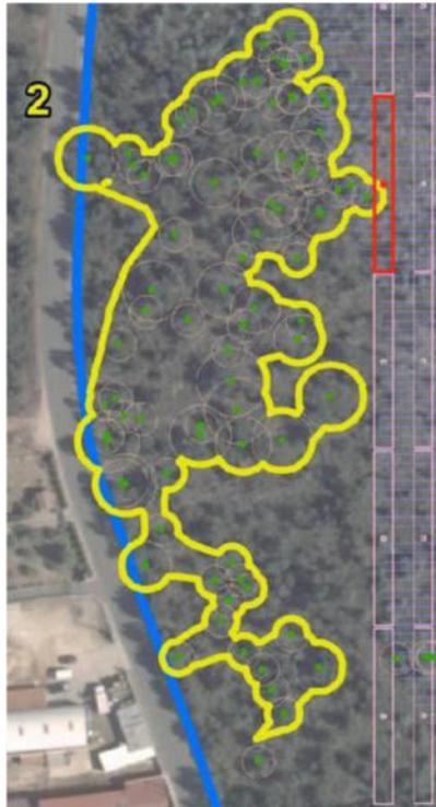
Figura 13 – Área A5-02 da CSF do Carregado (painéis a retirar identificados a vermelho; painéis a reduzir para metade identificados a verde)
