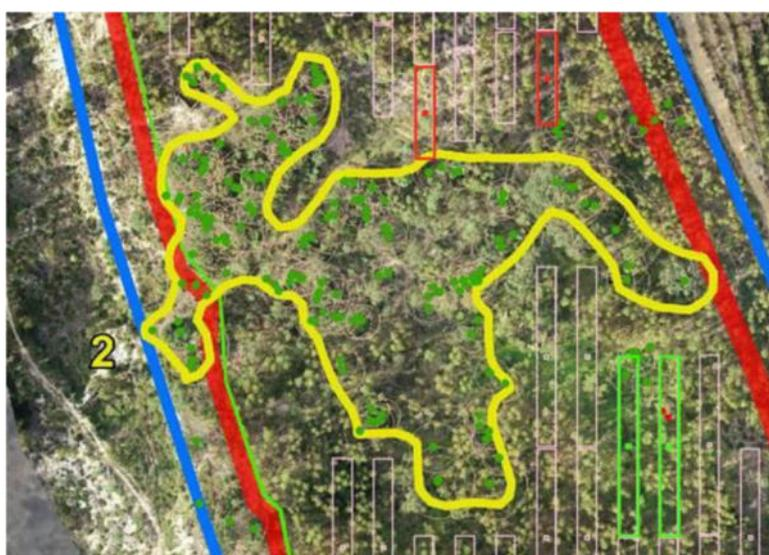
Figura 15 – Área A4-02 da CSF do Carregado (painéis a retirar identificados a vermelho; painéis a reduzir para metade identificados a verde).
