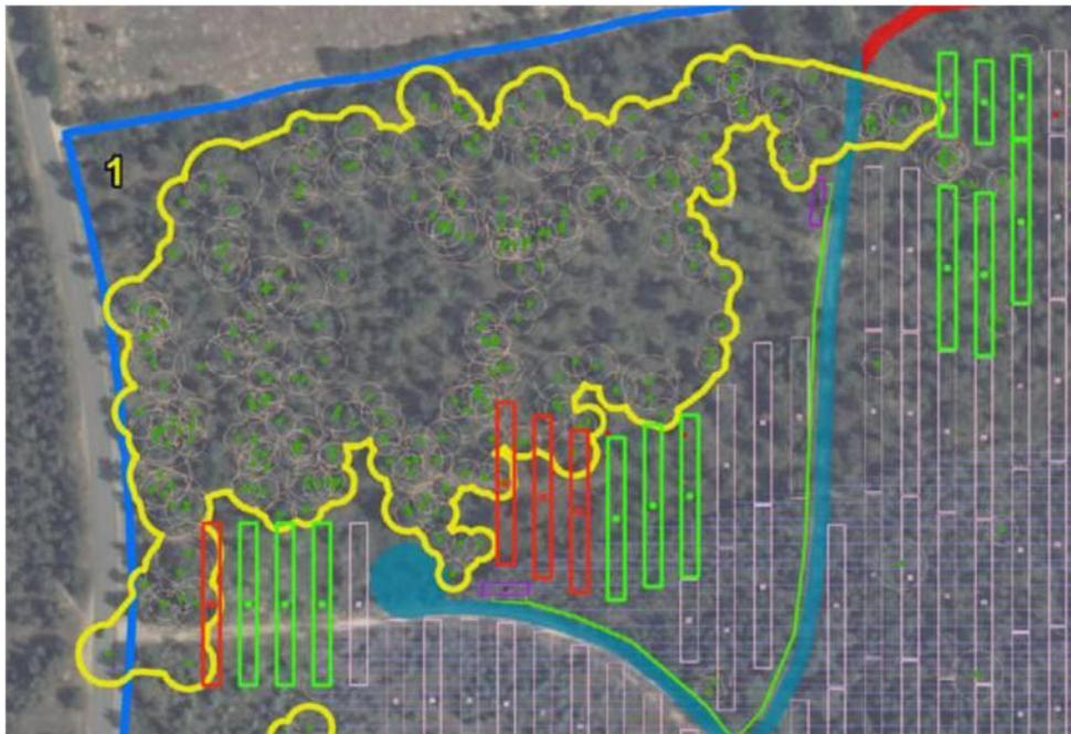
Figura 12 – Área A5-01 da CSF do Carregado (painéis a retirar identificados a vermelho; painéis a reduzir para metade identificados a verde)
