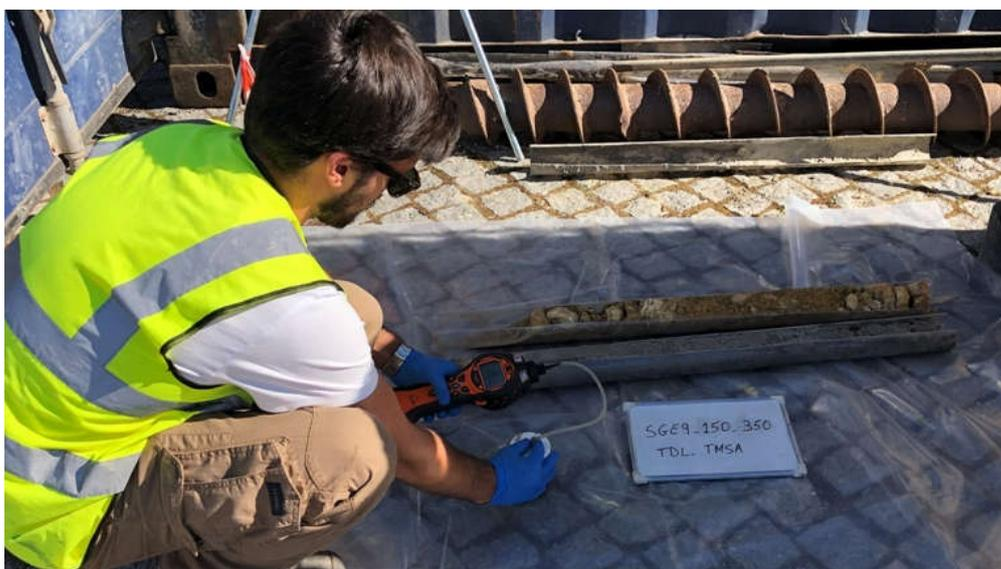
**Figura 8 – Despistagem da presença de COV através de equipamento PID**
