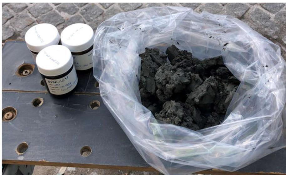
**Figura 5 – Amostra após homogeneização e antes da colocação em frascos para envio ao laboratório**
