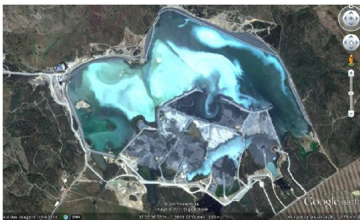
Fotografia 4.3 – IRCL – Evolução da exploração: transição da deposição subaquática para deposição subaérea de Rejeitados
