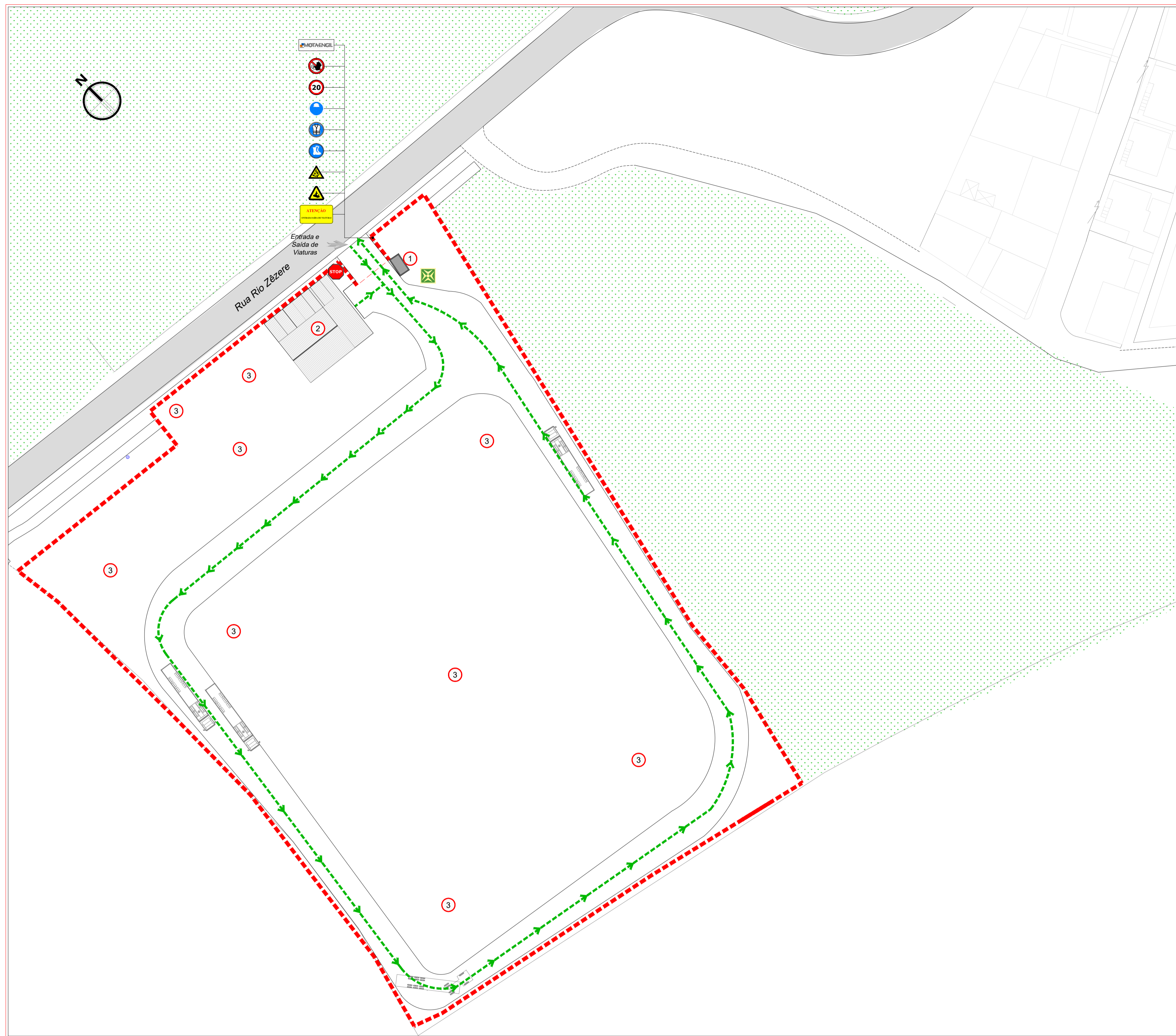
Planta de Estaleiro e Sinalização de Segurança A1 - Escala 1:500; A3 - Escala 1:1000
