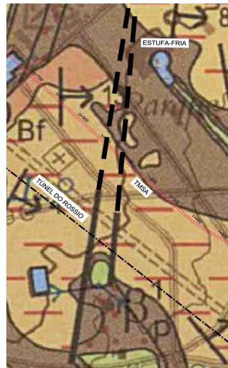
Figura 2.4 – Extrato da Carta Geológica 34-D mostrando o par de falhas cujo prolongamento para NE intersecta o traçado do túnel TMSA e o flanco da corta onde existe a ressurgência
