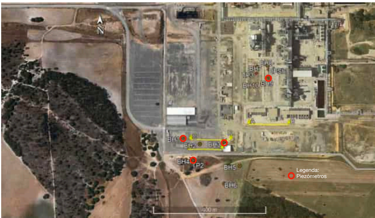
Figura 22 - Localização dos piezómetros instalados na zona da futura unidade HVO.
