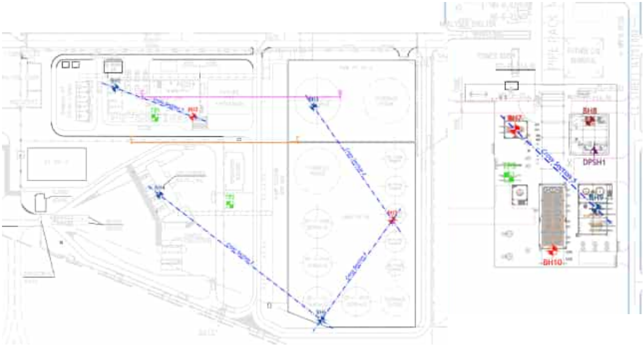
Figura 09: Sondagens geognósticas realizadas na zona da nova unidade HVO - GALP, Sines.
