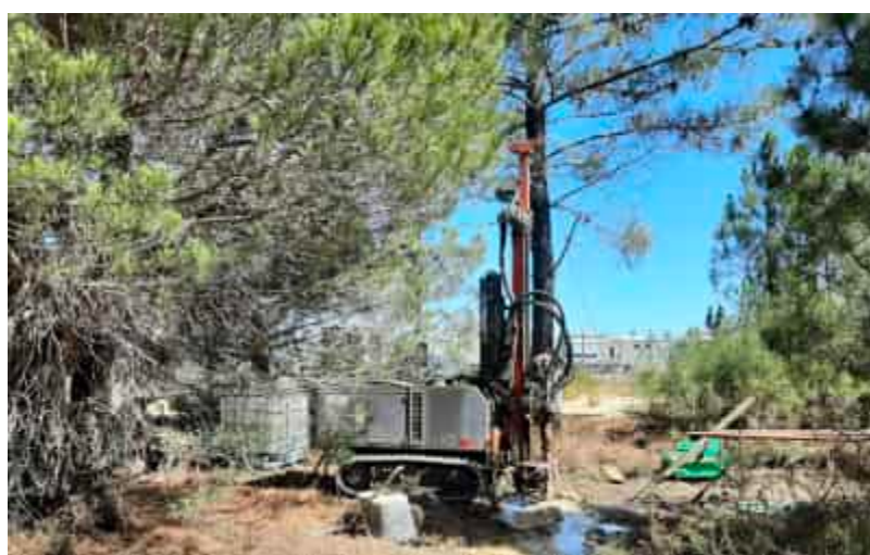
Figura 08: Registo Fotográfico da máquina sondagens in situ - HVO.
