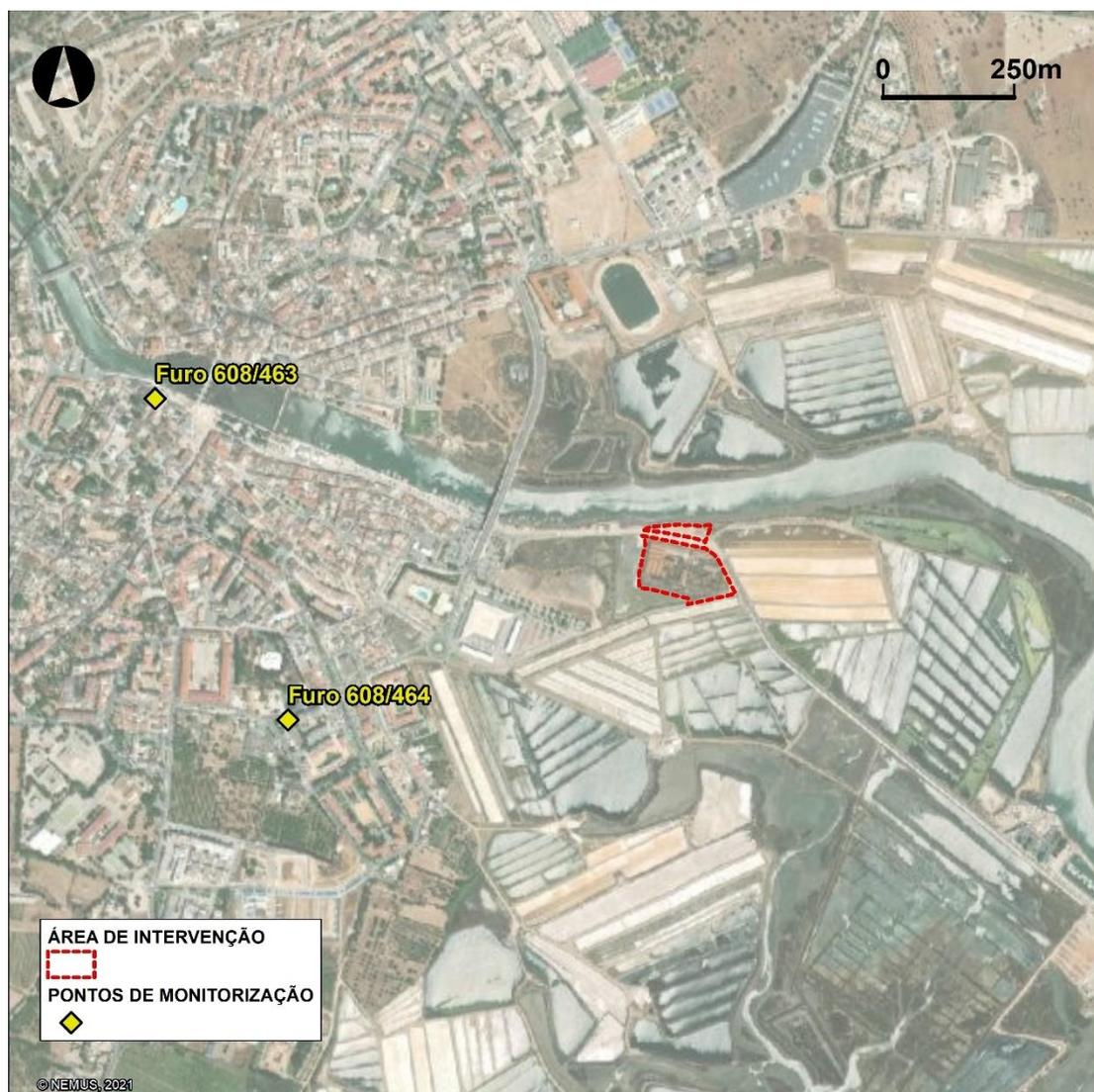
**Figura 32 – Localização da estação de monitorização de qualidade de água subterrânea e nascente “furo 608/463” e da estação de monitorização de nascentes “furo 608/464”, com área de estudo marcada a preto**
