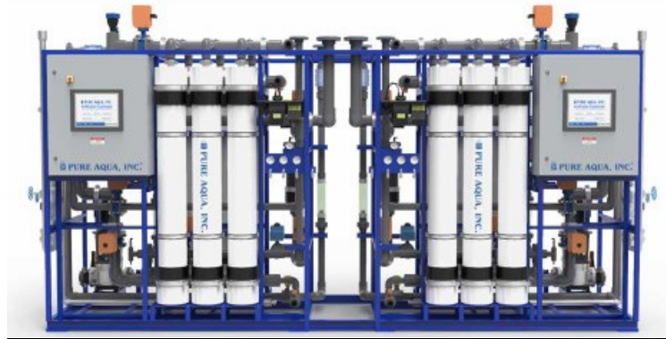
Figura 11 – Figura ilustrativa de um sistema de Ultrafiltração
