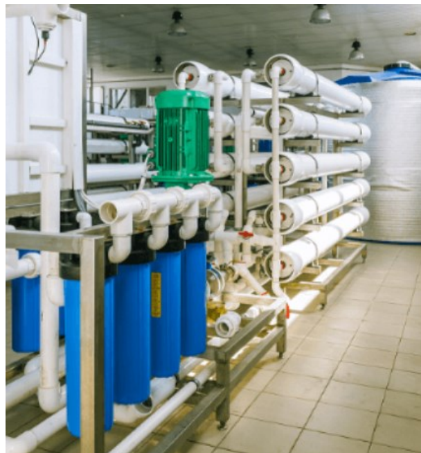
Figura 5 – Figura ilustrativa de uma unidade de produção de água desmineralizada, com Osmose Inversa e permuta iónica
