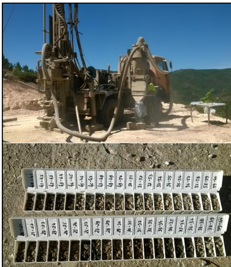
Figura II.32 - Sonda de circulação inversa e amostras recolhidas para registo geológico.
