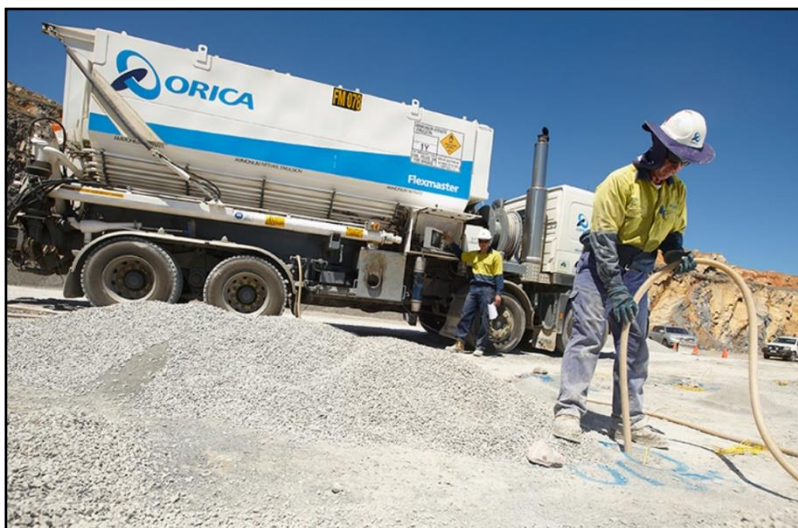
Figura II.93 - Exemplo da entrega de explosivos a granel © Copyright 2017 Orica Limited.
