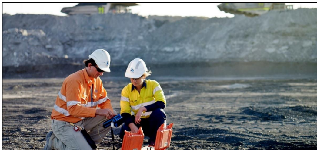
Figura II.96 - Técnicos a preparar a detonação de um desmorte © Copyright 2017 Orica Limited.
