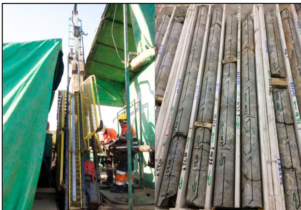
Figura II.33 - Equipamento de sondagens carotadas e amostras recolhidas para registo geológico.
