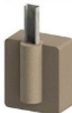
Figura 4.6 – Fundação de cravação direta no solo com pré-furação.
