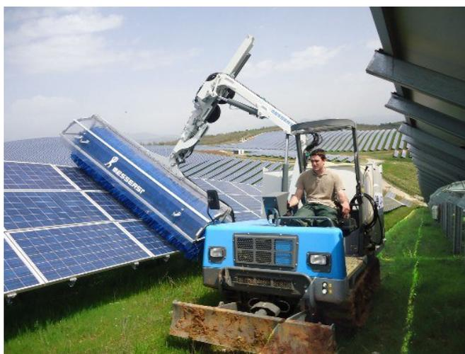
Fotografia 4.9 – Exemplo do equipamento para limpeza dos painéis fotovoltaicos.
