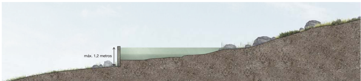
Fig. 11 Corte representando em perfil longitudinal uma linha de água temporária, represada com retenção de água e de sedimentos.
