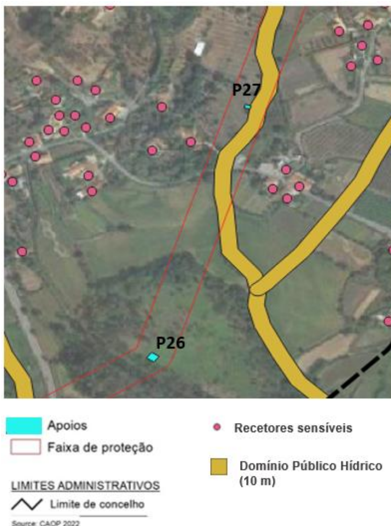
Figura 6.3 – Atravessamento de uma linha de água e respetivo Domínio Público Hídrico paralelamente entre os apoios P26 e P27
