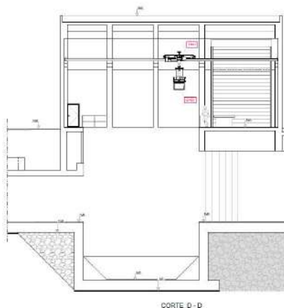
Local de Instalação da Ponte Rolante com Colher Hidráulica
