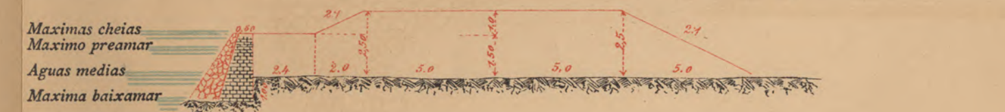
CORTE TRANSVERSAL DAS MOTAS DO CANAL DE ESPINHEIRO EM CONSTRUÇÃO ESCALA \frac{1}{200}
