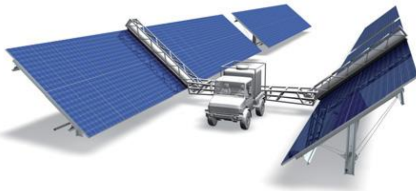
Figura 4.17 – Limpeza por Braço Mecânico
