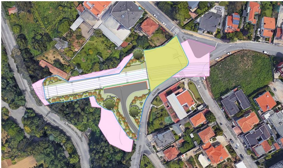
Figura 3.17 - Integração na malha urbana da transição entre o VSO e o emboquilhamento do túnel, com novo arruamento para acesso a carro de bombeiros (Fonte: Google Earth)
