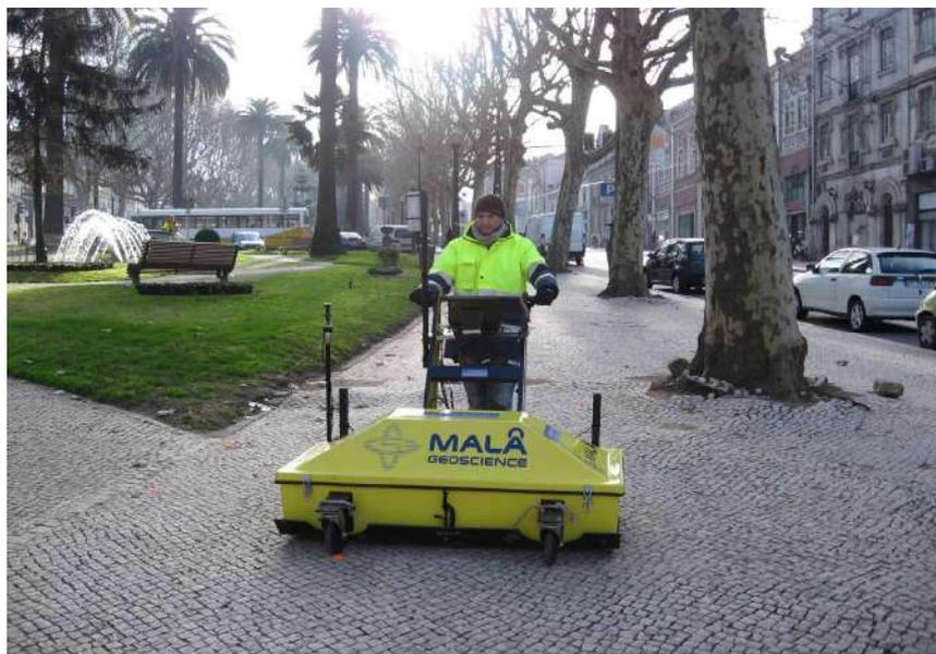
*Figura 2 - Sistema tridimensional Mira 3D da Mala Geoscience equipado com antenas de frequência central de 400MHz.*
