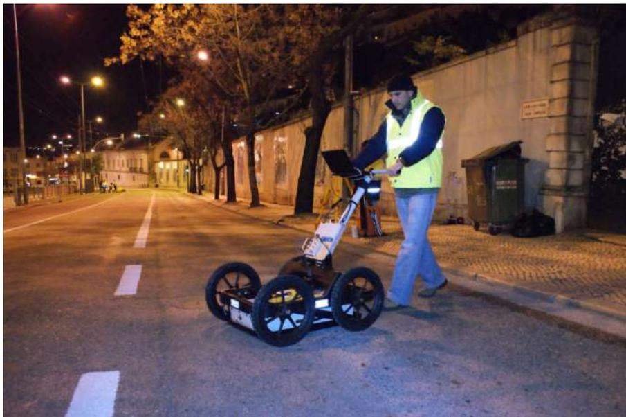
*Figura 1 - Sistema Cart da Mala Geoscience equipado com antenas de frequência central de 250MHz.*
