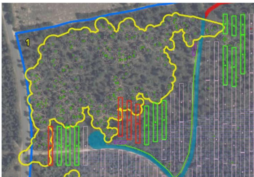
Figura 1 – Área A5-01 da CSF do Carregado (painéis a retirar identificados a vermelho; painéis a reduzir para metade identificados a verde).
