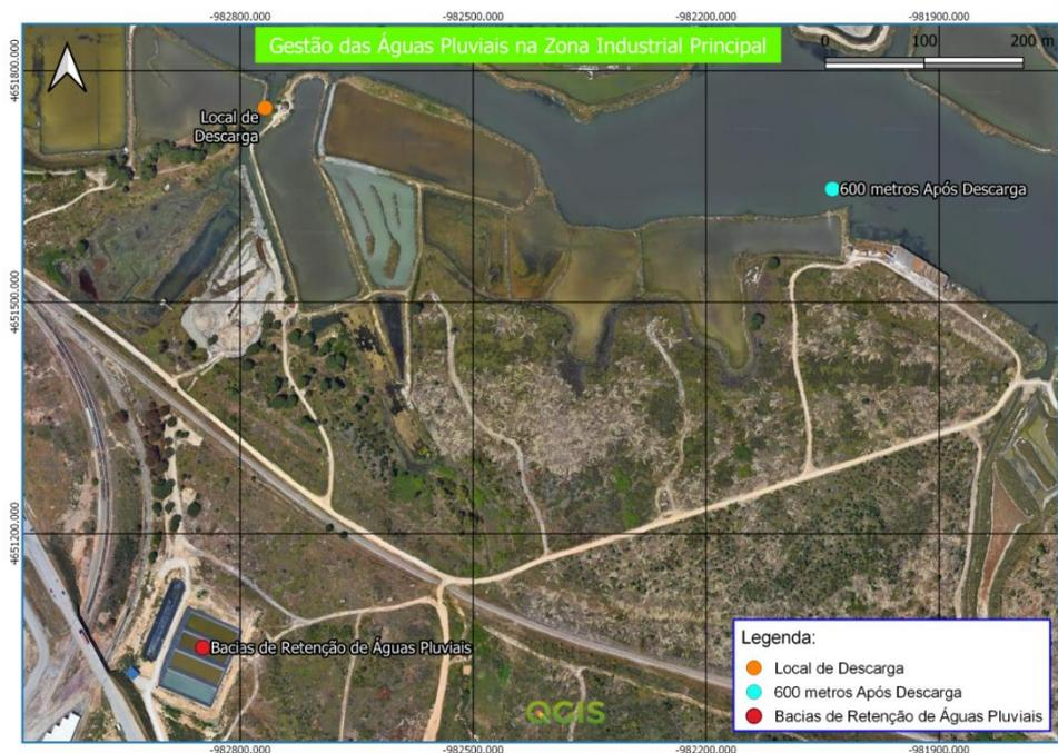
Figura 1- Enquadramento das bacias de retenção de águas pluviais e locais de amostragem do meio hídrico.
