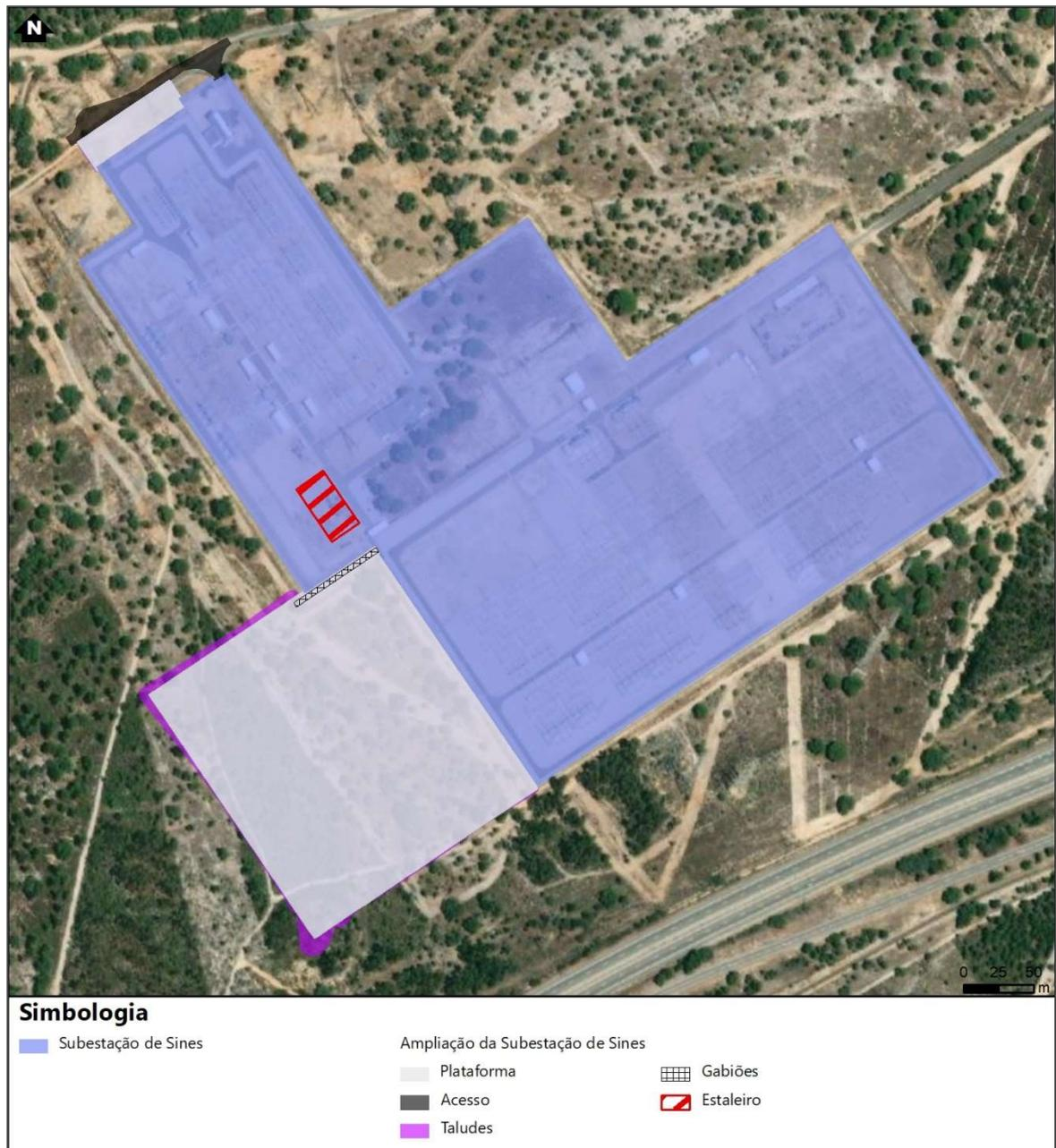
Figura 4.4 – Ampliação da subestação de Sines (SSN) – Implantação geral
