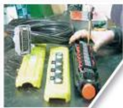
Cableado de botonera Pendant control wiring
