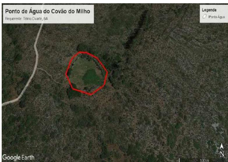
Muito sucintamente, o projeto de construção do “Ponto de Água do Covão do Milho” consistiu no desaterro desta área de modo a criar uma depressão côncava e semicircular, capaz de obter a máxima capacidade de captação de água. Seguiu-se a colocação de manta de geotêxtil em contacto com a terra, antes da geomembrana de alta resistência mecânica e contra os raios UV,
