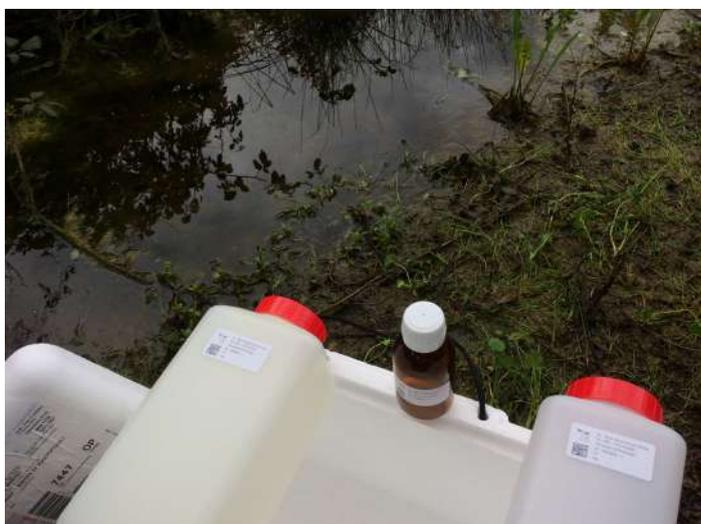
**Foto 7** - Aspeto particular do local e dos recipientes que constam do KIT fornecido pela AGQLabs, com caixa em esferovite para transporte da amostra, e recipientes de recolha de material distinto para controlo de eventuais contaminações com origem no próprio material dos recipientes.
