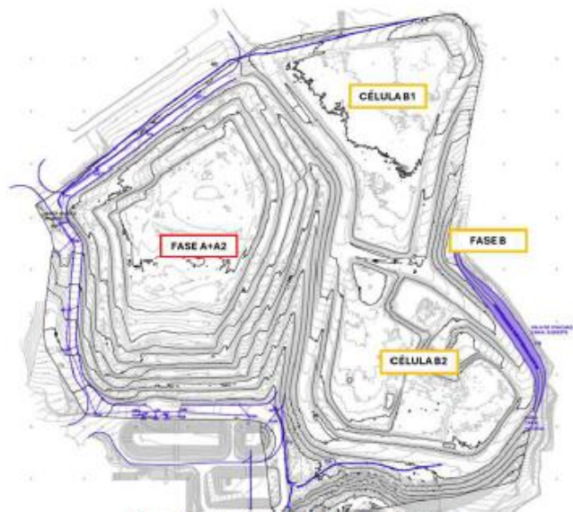
Figura 9-1 – Rede de drenagem pluvial existente
