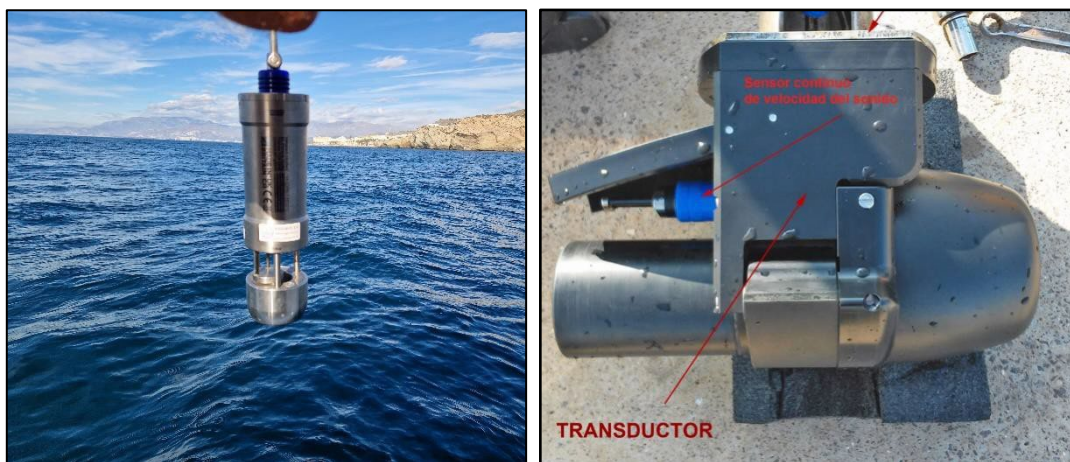
Figura 5. SVP e transdutor de sonar multifeixe e sonar de varredura lateral com sensor SVP integrado.
