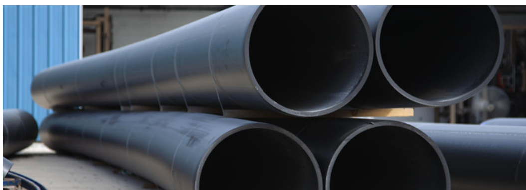
Ilustração 7. Armazenamento de tubos em dois níveis.
