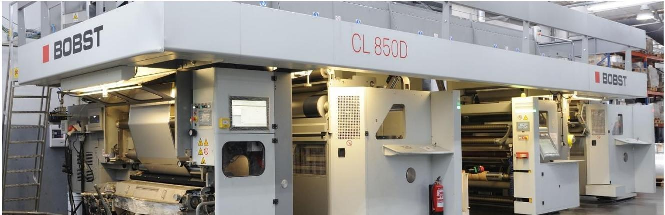
Figura 2.16 - Registo fotográfico de um equipamento de complexagem com solvente
