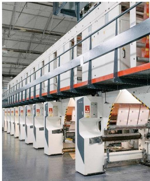
**Figura 2.15** - Registo fotográfico de um equipamento de impressão por rotogravura
