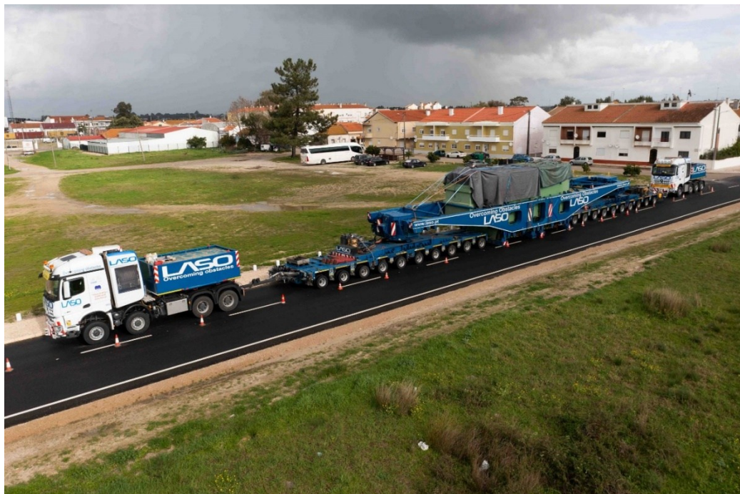
Fotografia 1 – Fotografia exemplificativa do Transporte de Transformador de Potência
