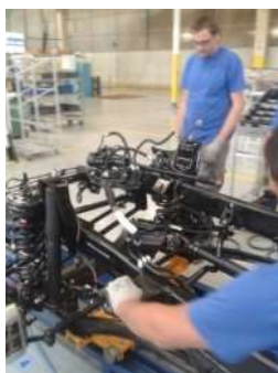
Figura 7 – Montagem de chassis
