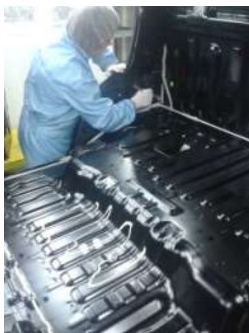
Figura 4 – Aplicação de vedantes e PVC
