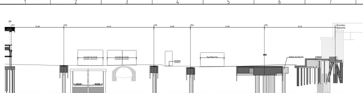
**FASE 1:** Execução das estacas e maciços de fundação dos pilares e encontro, e execução das contenções do futuro túnel ferroviário, de acordo com as metodologias e faseamentos definidos no projeto específico. O pilar P1 pertencente à estrutura da estação já foi montado anteriormente.
