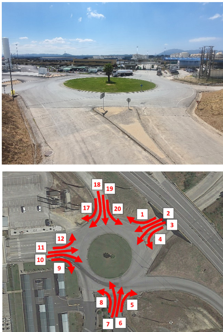
Figura 9 | Posto 1: Fotografia e esquema de movimentos
