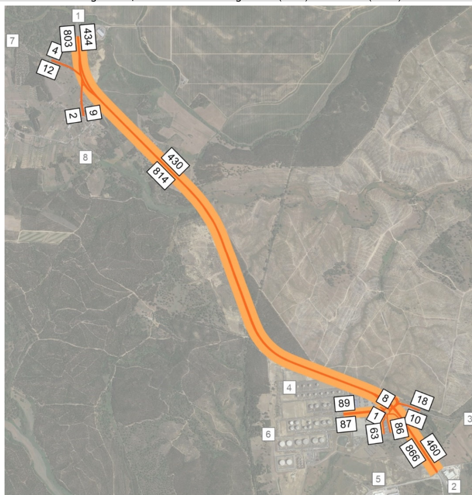
Figura 24 | Estimativas de tráfego atual (2024) na HPM-DU ( uvl/h )
