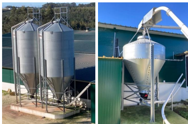
Figura 3.2.1. Exemplos de silos principais (à esquerda) e silos da ração diária (à direita).
