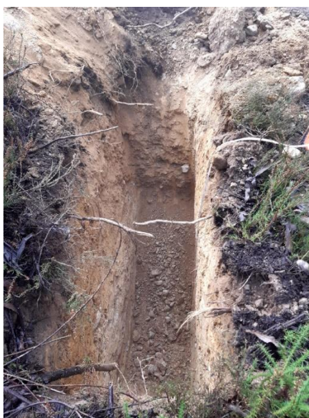
Figura 4.16.1. Poço de prospeção evidenciando areias siltsas.
