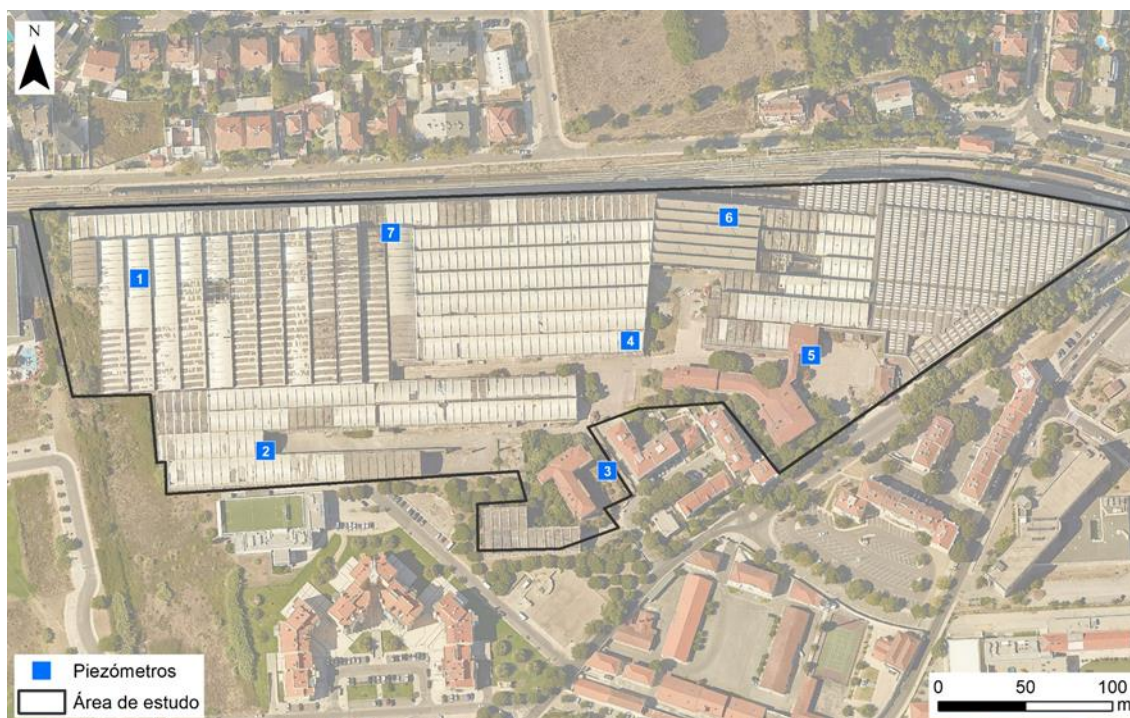
Figura 5.5.2 – Localização dos piezómetros (Imagem de fundo: Google Earth).
