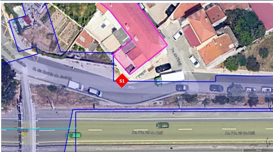
Figura 25 – Localização da sondagem de diagnóstico junto ao alçado sul. A azul marca-se os limites das novas vias a construir no âmbito da Estação de Alcântara, a rosa os limites do antigo Palácio Fiúza.
