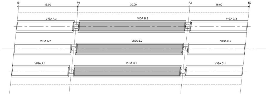
PLANTA DE DISTRIBUIÇÃO DAS VIGAS PRÉ-FABRICADAS
