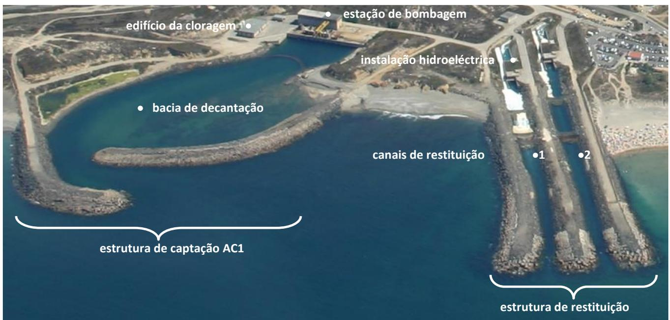
Figura 1 – Estruturas de captação e restituição/descarga do Circuito de Água de Refrigeração (CAR)
