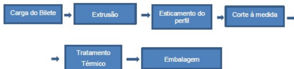
Figura 3 - Estágios do processo de extrusão
