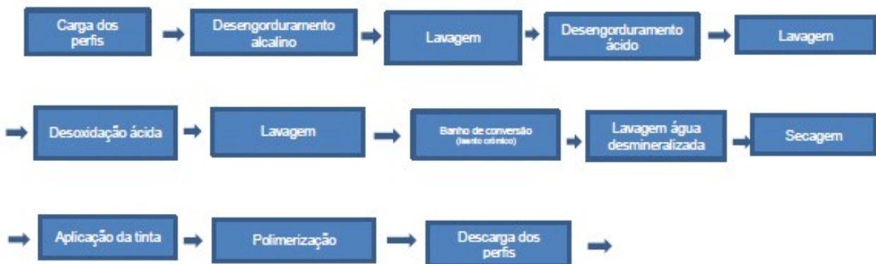
Figura 6 - Estágios do processo de lacagem horizontal
