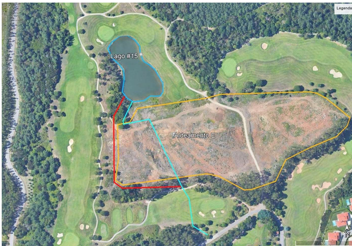
LAGO #15. COLETOR DE DESCARGA ANTIGO (AZUL) E NOVO (ENCARNADO)
