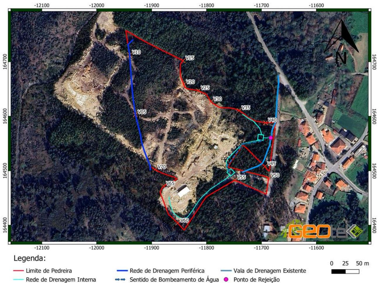
Figura 18 - Ilustração da rede de drenagem a implantar na exploração.
