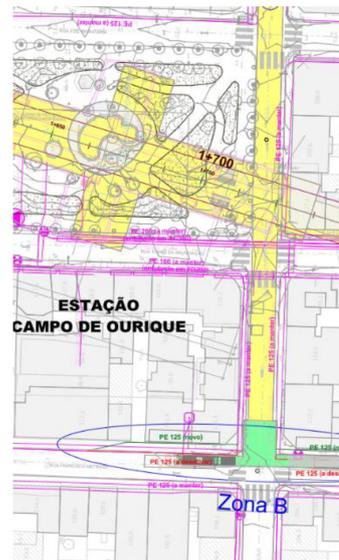
Na zona B, existe efetivamente interferência com as redes existentes devendo desativar-se parcialmente a rede e construir-se trajeto paralelo conforme representado.
