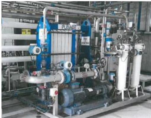
**Figura 10 – Módulo de Ultrafiltração**
