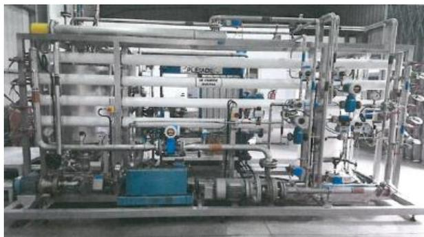
**Figura 11 – Módulo de Osmose Inversa**
