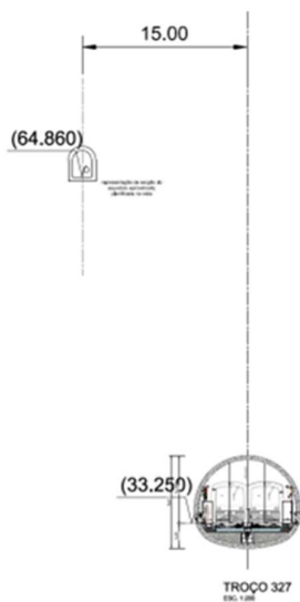
Figura 25 - Interferência 327 (considerando a alteração altimétrica do traçado)
