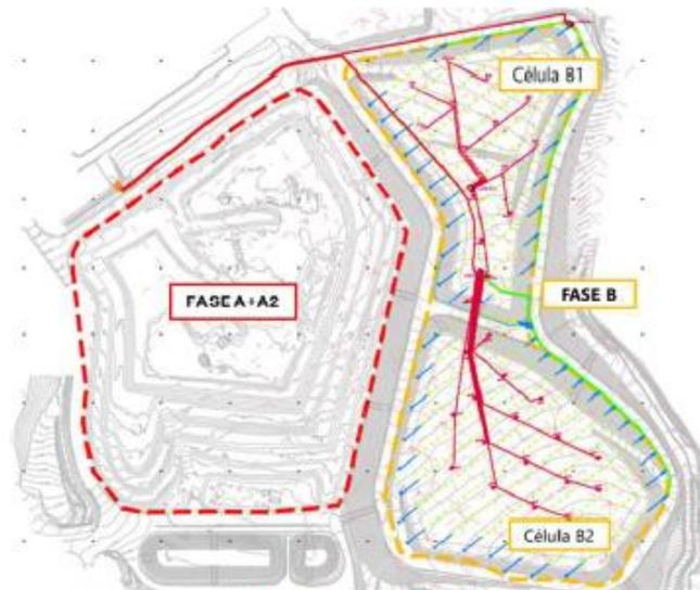
Figura 6-4 – Rede de drenagem de biogás existente e prevista da Fase B
