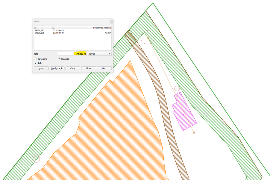
Figura 18: Medição da distância entre a captação e a descarga do separador de hidrocarbonetos.
