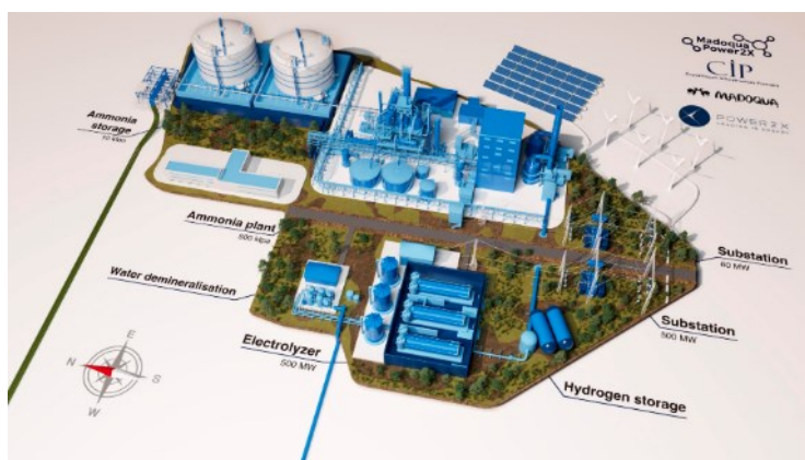
Figura 2.2 – Representação esquemática da fábrica de hidrogénio e amoníaco. 45
