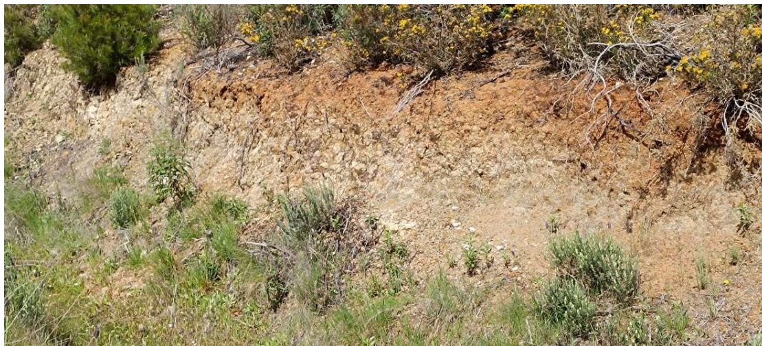
Figura 2.16 - Aspeto das argilas esbranquiçadas e alaranjadas existentes num talude de um caminho de terra-batida.
