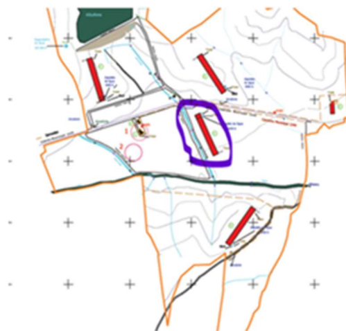
Fig. 1 – Planta de implantação dos edifícios associados ao projeto (edifício assinalado não interfere com linha de água).
