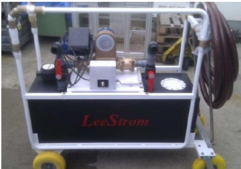
Fotografia 3 – Depósito móvel para remoção das águas residuais utilizado no Porto do Recreio de Olhão.
