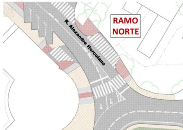
Para o ano horizonte, 2037, estimam-se com a rotunda atual, conforme apresentado no ET (em anexo) más condições de circulação nos ramos da rotunda, com nível de serviço entre “E” e “F”, exceto no ramo sul, em que se estimam condições de circulação satisfatórias, com nível de serviço “D”.
