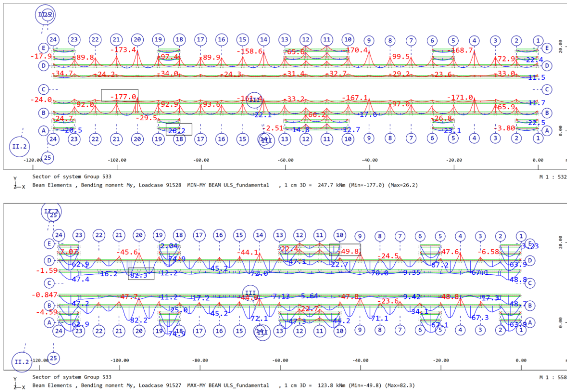
Figura 76 – Envolvente mínima e máxima – ULS Fundamental – Piso 2 Via – Direção Longitudinal
