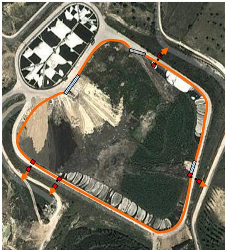
Figura 2 - Rede de drenagem de águas pluviais.
