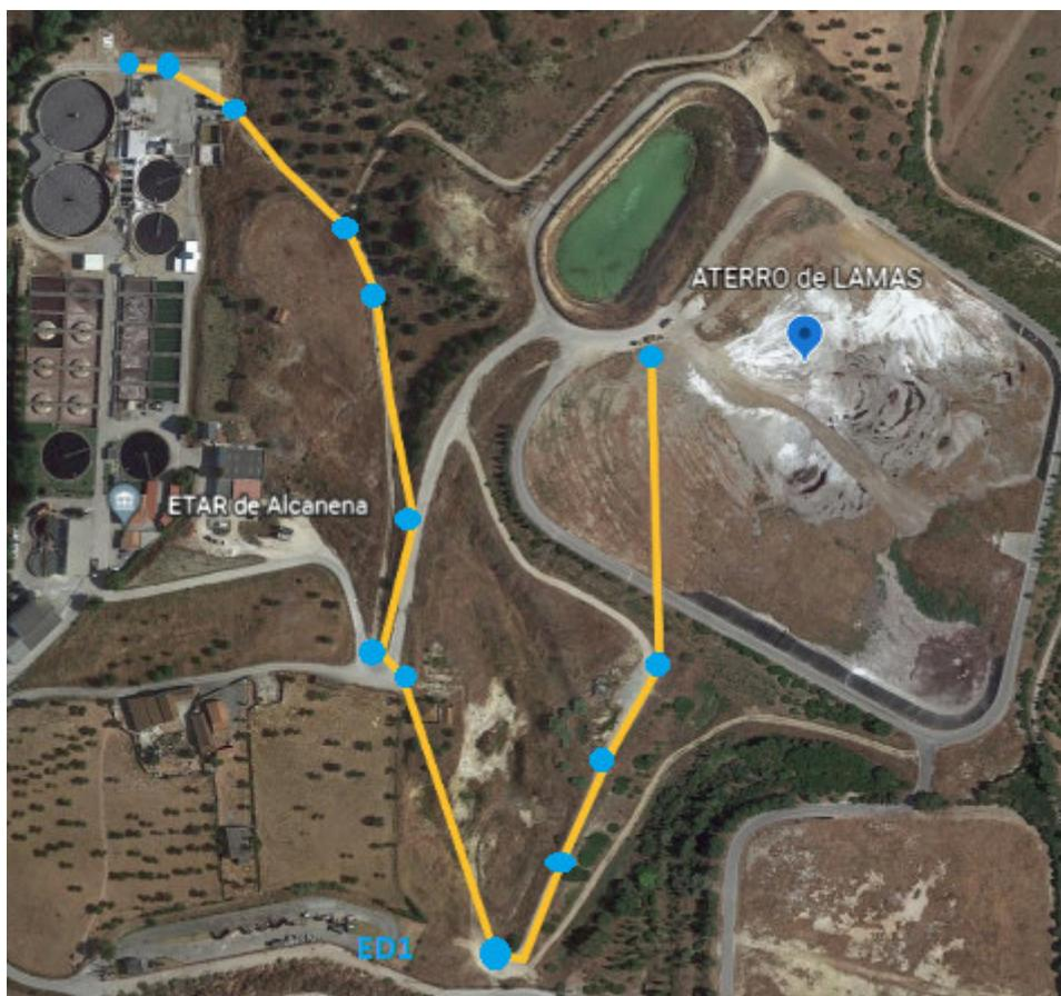
Figura 3 - Rede de drenagem de águas lixiviantes
