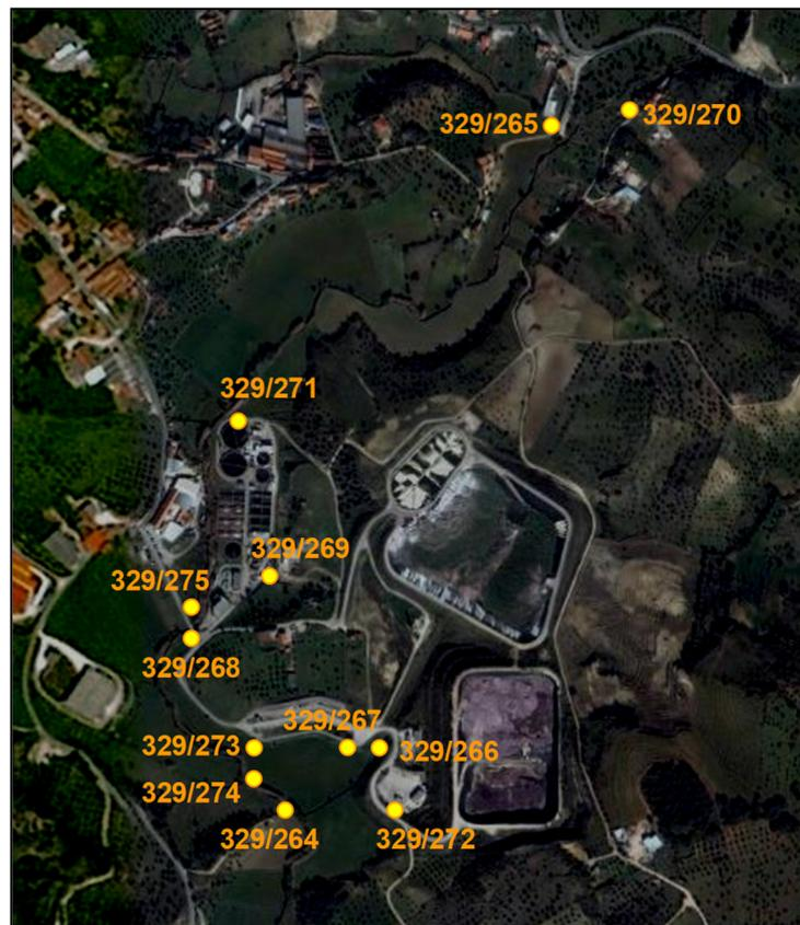
Figura 5 - Localização no terreno dos pontos de recolha de águas subterrâneas – classificação do INAG
