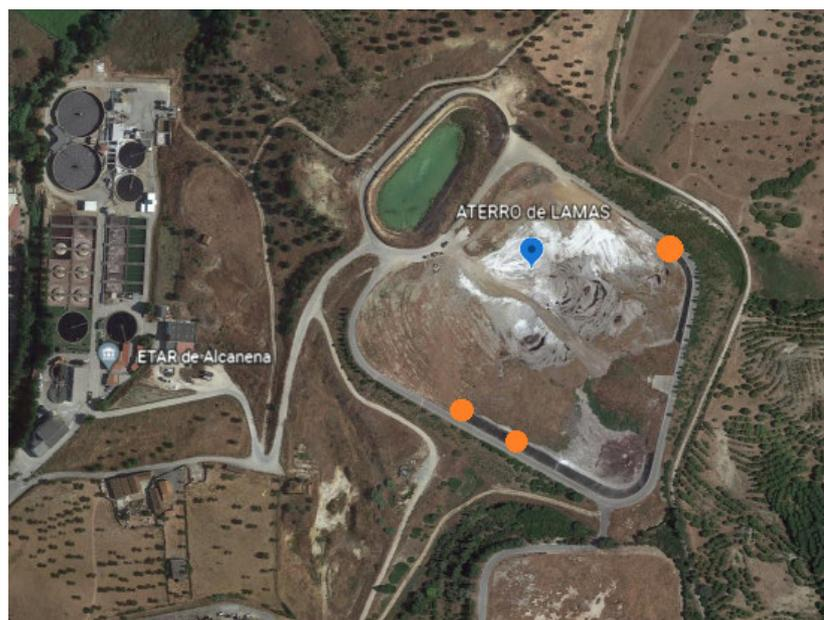
Figura 1 - Identificação da localização dos tubos de escoamento de biogás.
