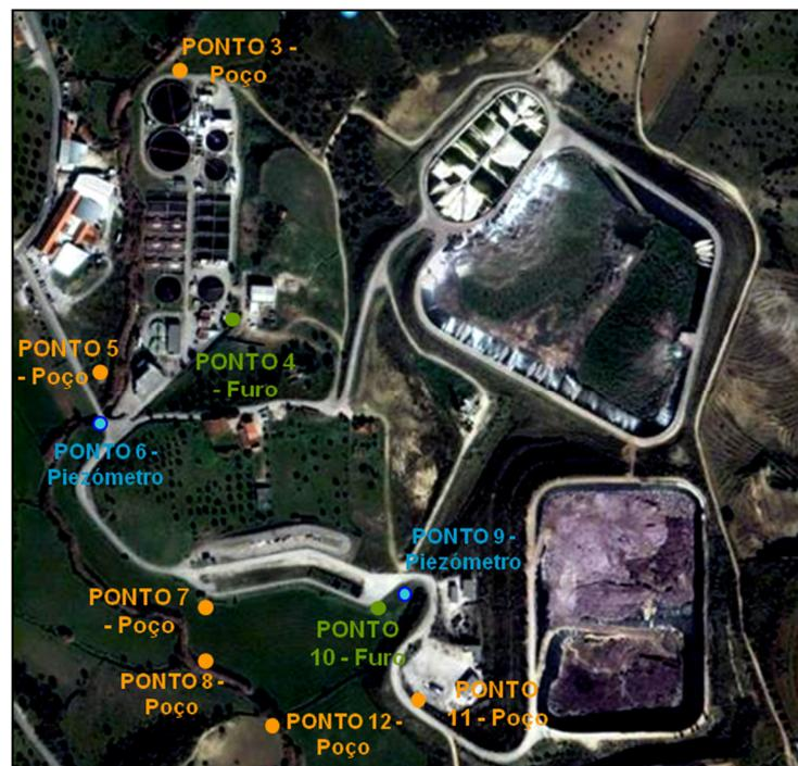
Figura 6 – Tipologia dos pontos de recolha de águas subterrâneas – jusante do aterro
